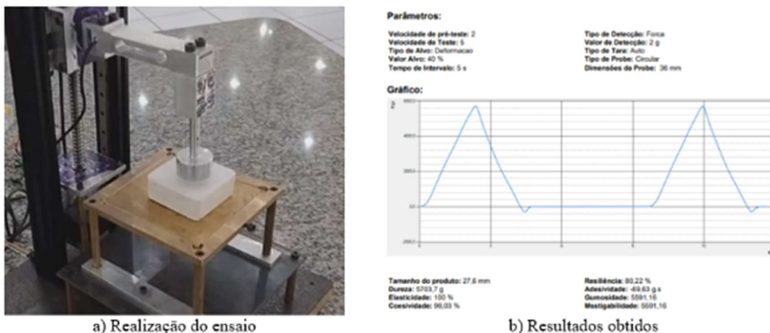
Figura 11 – Ensaio do bloco de silicone
