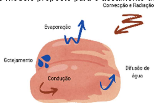
Figura 2 - Representação esquemática dos mecanismos de transferência de calor e massa considerados no modelo proposto para o assamento do peito de frango.
