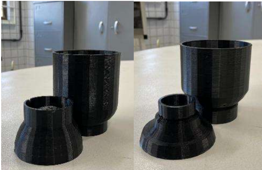
Figura 7 e 8 – Fôrmas impressas em PLA e PETG respectivamente
