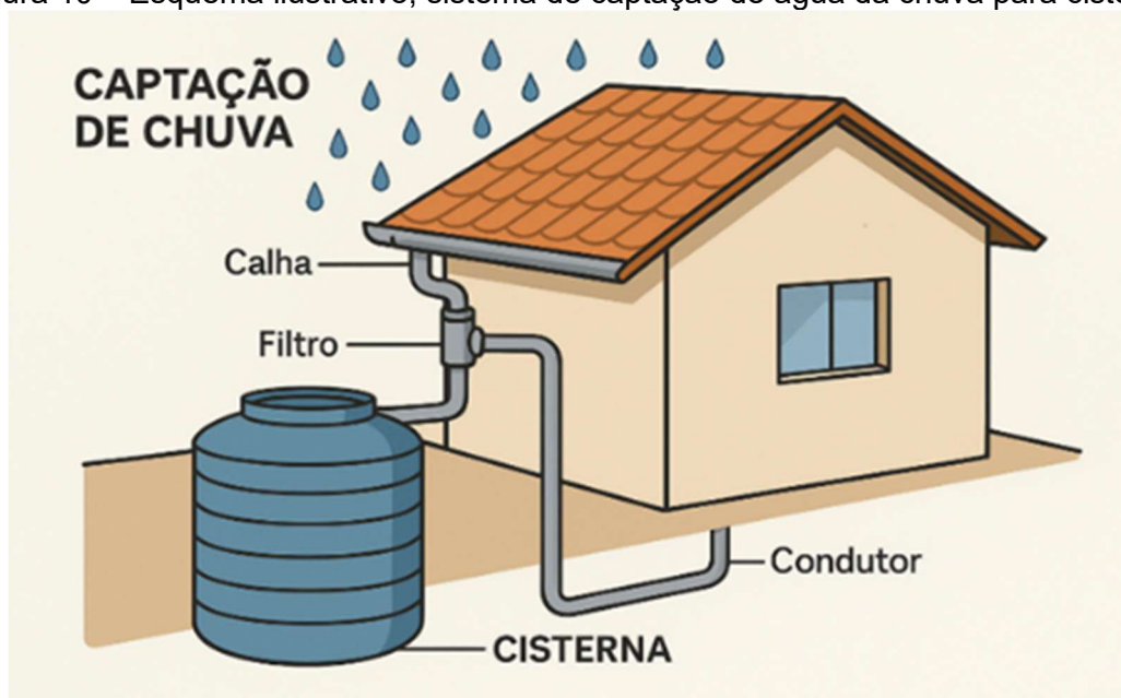
Figura 10 – Esquema ilustrativo, sistema de captação de água da chuva para cisterna.
