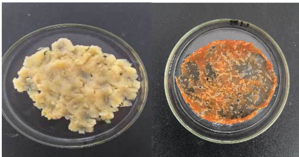
Figura 6 - Pectina úmida após lavagem com álcool 96% e após secagem em estufa com circulação de ar.
