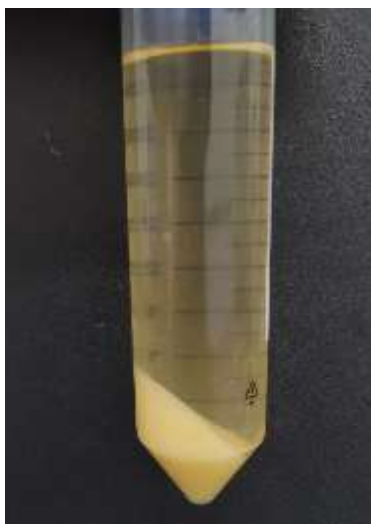
Figura 5 - Pectina precipitada após centrifugação
