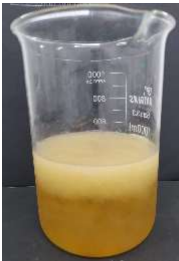
Figura 4 - Precipitação da pectina após 24h em álcool 96%
