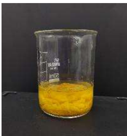
Figura 3 - Teste qualitativo para determinação de pectina em polpa de araticum-do-brejo.
